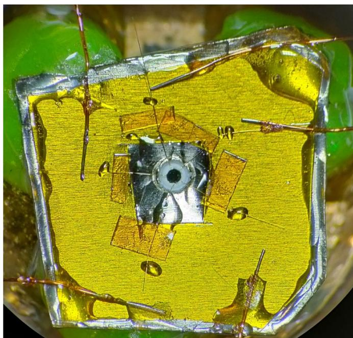
图 2.10 金刚石压力胞样品台实物图。
